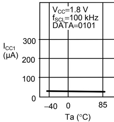
1.4 读出时消耗电流(I<sub>CC1</sub>) — 电源电压(V<sub>CC</sub>)
