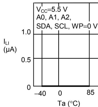
1.13 输入泄漏电流( $I_{LI}$ ) — 周围温度( $T_a$ )
