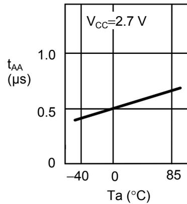
2.7 SDA 输出延迟时间( $t_{AA}$ ) — 周围温度( $T_a$ )
