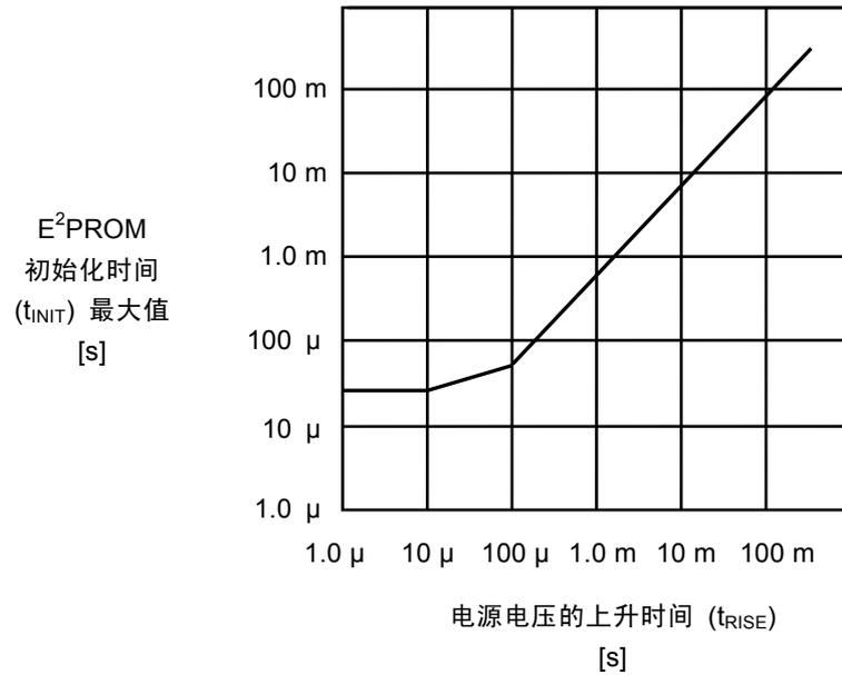
图 29 S-24CS01A/02A/04A/08A 的初始化时间
