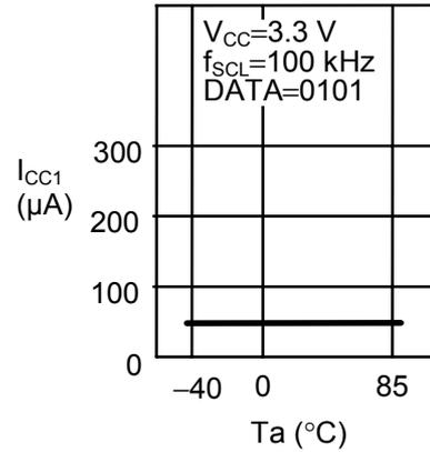
1.3 读出时消耗电流(I<sub>CC1</sub>) — 周围温度(Ta)
