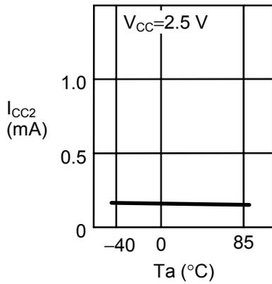
1.10 程序解析时消耗电流(I<sub>CC2</sub>) — 电源电压(V<sub>CC</sub>)
