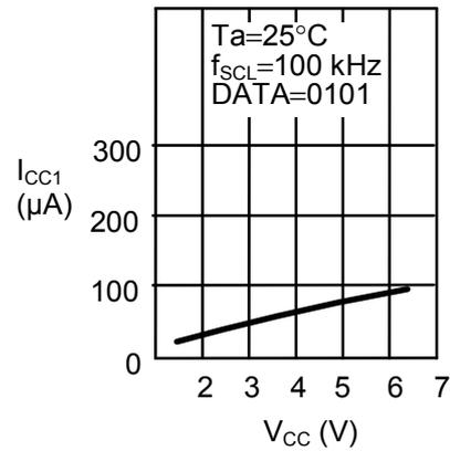
1.5 读出时消耗电流(I<sub>CC1</sub>) — 电源电压(V<sub>CC</sub>)
