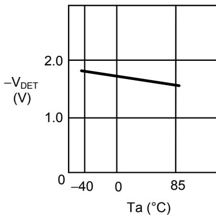
1.24 低电源解除电压(+V<sub>DET</sub>) — 周围温度(Ta)
