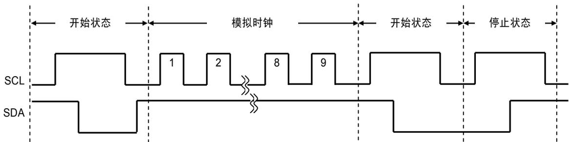
图 26 S-24CS01A/02A/04A/08A 的复位方法
