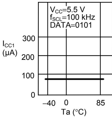
1.2 读出时消耗电流(I<sub>CC1</sub>) — 周围温度(Ta)
