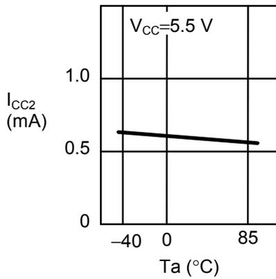
1.8 程序解析时消耗电流(I<sub>CC2</sub>) — 周围温度(Ta)
