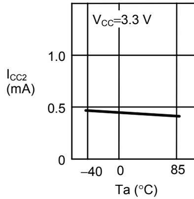
1.9 程序解析时消耗电流(I<sub>CC2</sub>) — 周围温度(Ta)
